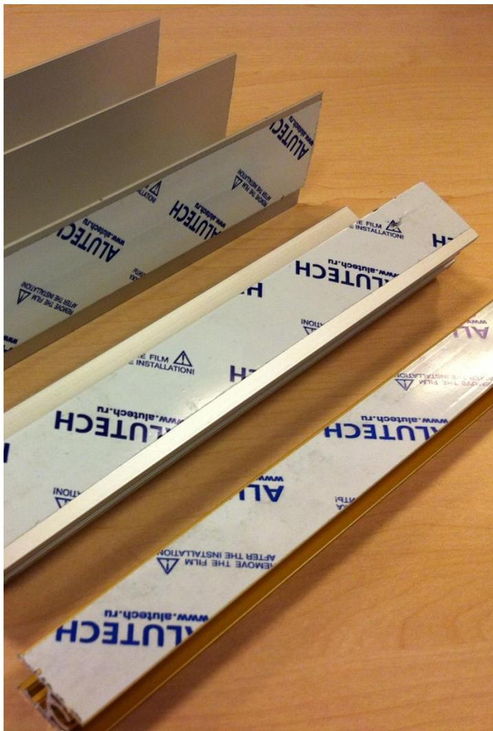
Для обеспечения сохранности и высоких декоративных свойств покрытия в процессе упаковочных работ, хранения и эксплуатации на поверхность анодированных профилей\* наносится специальная защитная пленка
