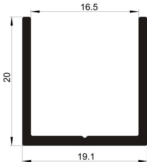
Высокие боковые стенки профиля обеспечивают возможность регулировки фальш-панелей в процессе монтажа, компенсируя тем самым неровности стен
