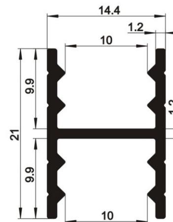
**Разделитель-наклейка** АУРС.000.0025 для имитации деления двери на фрагменты может быть установлен в любом положении
